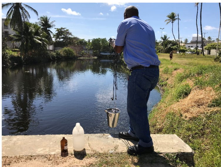
Figura 3.7: Coleta de amostra no Ponto 03. Fonte: SEMARH, 2018.
